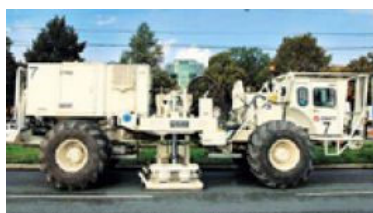
Das riesige Vibro-Seismik-Fahrzeug mit den tonnenschweren Vibroplatten
